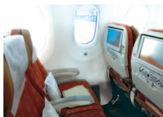
透過率をコントロールできる電子式遮光機能付き大型窓
